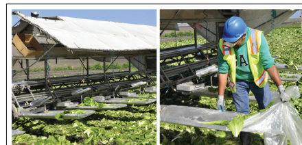
Paso 1. Limpieza en seco
